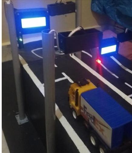
Gambar 5. Pengujian Pendeteksian Objek Oleh Sensor Ultrasonik
