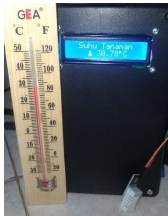
Gambar 16. Pengujian Sensor DHT22
