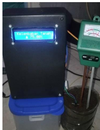
Gambar 15. Pengujian Sensor Kelembaban Tanah
