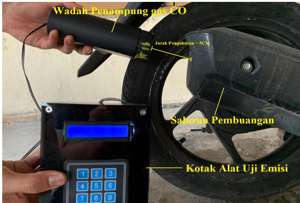
Gambar 6. Proses Pengujian Alat Uji Emisi
