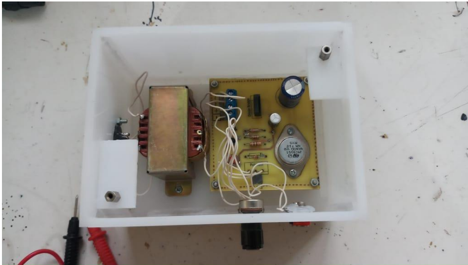
Gambar 2. Rangkaian Elektronik Catu Daya Variable 0-30 Volt
