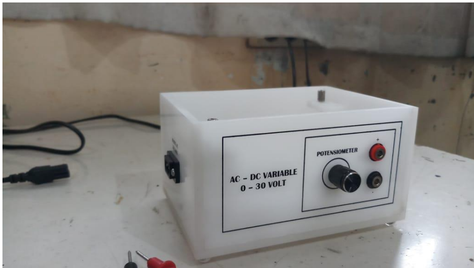
Gambar 3. Box Catu Daya Variable 0-30 Volt
