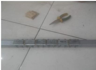
Gambar 3.4 Torak dengan Magnet 1 sisi
