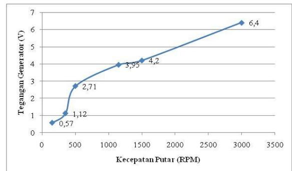
Gambar 9 Tegangan generator saat tanpa beban
