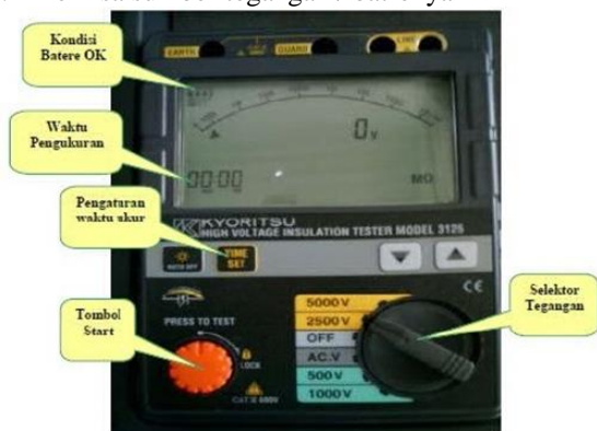
Gambar 9. Mengecek sumber tegangan / batrei
