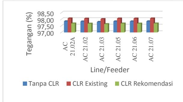
Fig. 9. Tegangan masing-masing *feeder* pada substation AC 21 per-studi kasus
