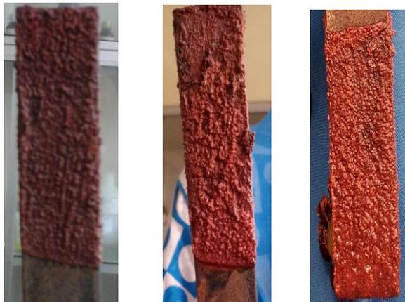
Gambar 3 Hasil Elektroplating Baja Karbon Rendah pada Suhu 65<sup>0</sup>C berurutan selama 10, 20, dan 30 menit
