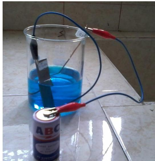
Benda kerja yang telah dibersihkan dielektroplating menggunakan sumber arus searah dengan tegangan 6 volt. Baja karbon rendah dihubungkan dengan kutub positif sumber arus dan kawat tembaga dihubungkan dengan kutub negative sumber arus. Lamanya proses elektroplating bervariasi yaitu 10, 20, dan 30 menit dengan suhu  $45^{\circ}C$ ,  $55^{\circ}C$  dan  $65^{\circ}C$ .
