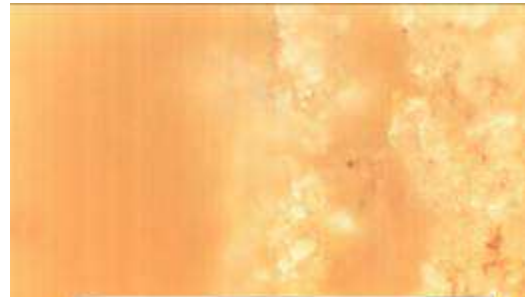
Gambar 3. Mikrograf sampel keramik piezoelektrik berdiameter 4 cm tanpa perlakuan asam dengan perbesaran 100X.
