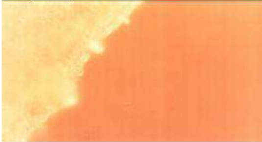
Gambar 5. Mikrograf sampel keramik piezoelektrik berdiameter 4 cm dengan perlakuan asam pada perbesaran 100X.
