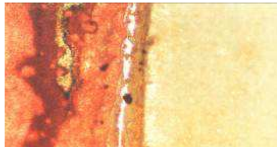
Gambar 4. Mikrograf sampel keramik piezoelektrik berdiameter 4 cm dengan perlakuan asam pada perbesaran 5X.
