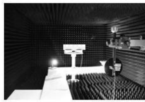
Gambar 6 Foto pengukuran antenna dalam anechoic chamber.
