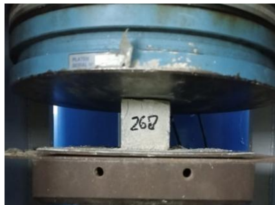
Gambar 8. Pengujian Kuat Tekan Mortar
