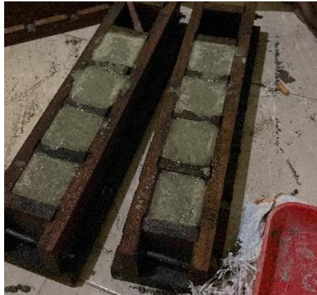
Gambar 2. Pembuatan benda Uji
