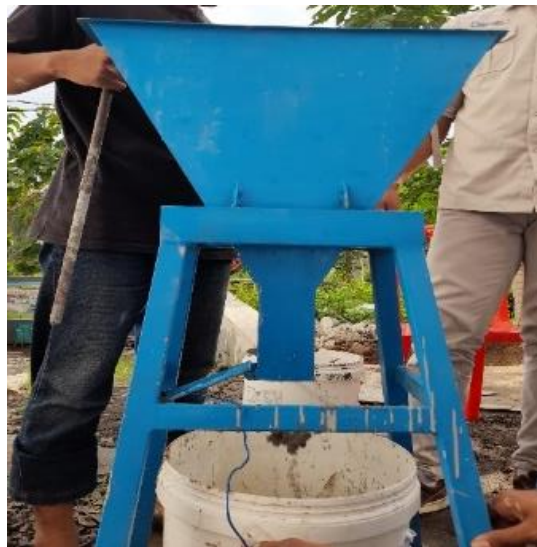
Gambar 7. Uji slump menggunakan V-funnel tester
