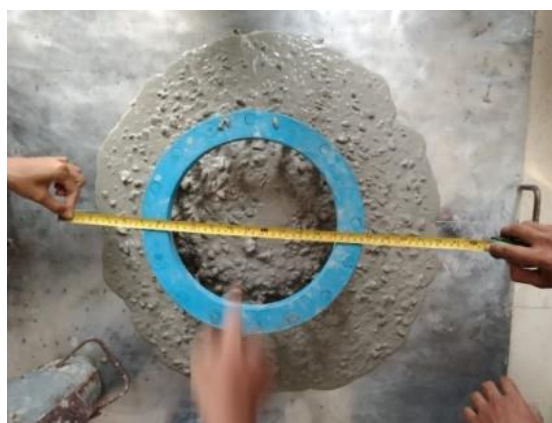
Gambar 5. Uji slump menggunakan J-ring Tester
