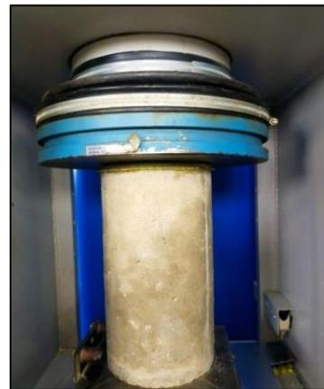
Gambar 7. Pengujian Kuat Tekan Beton
