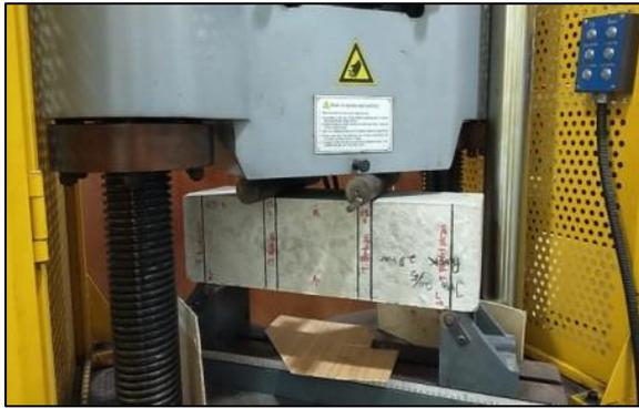
Gambar 11. Pengujian Kuat Lentur Beton
