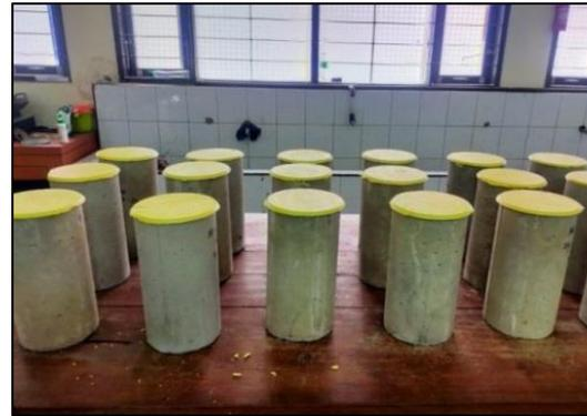
Gambar 12. Proses *Capping* Benda Uji
