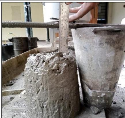
Gambar 4. Hasil Pengujian Slump
