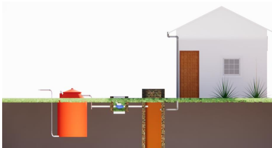
Gambar 9. Prinsip kerja Sumur resapan komunal
