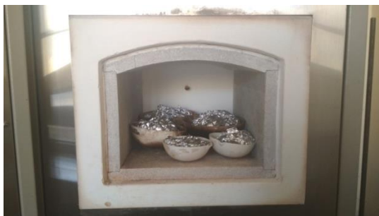
Gambar 1. Pembakaran Sekam Padi Menggunakan Furnace
