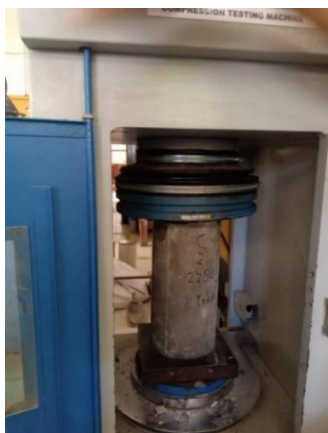
Gambar 4. Pengujian Kuat Tekan Beton
