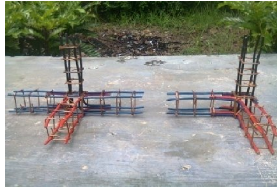
Gambar 2. Model penulangan hubungan kolom dan balok
