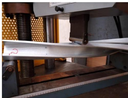
**Gambar 5. Kegagalan Tekuk Torsi Lateral pada Baja Ringan Rakitan sampel BJR-1-75.**
