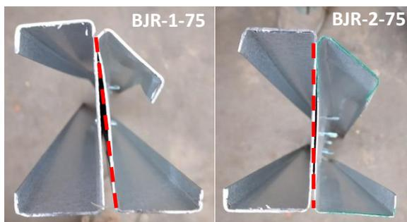
**Gambar 3. Perbandingan slip sampel pada bagian badan (web) yang disambung**
