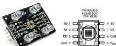
Gambar 2. Bentuk dan Skema pin TCS230
