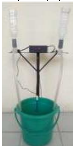
Gambar 10. Instrumen Sistem Pengontrolan pH Larutan Hidroponik
