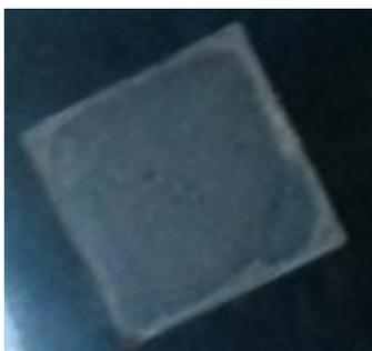
Gambar 5. Lapisan nanokomposit  $CoFe_2O_4$ /PVDF variasi 10 ml : 10 ml
