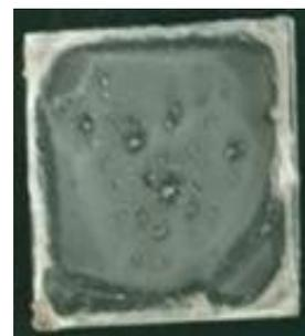
Gambar 7. Lapisan nanokomposit  $CoFe_2O_4$ /PVDF variasi 10 ml : 30 ml
