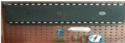
Gambar 11. Rangkaian Mikrokontroler ATMEGA 8535
