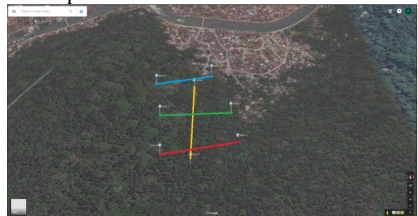
Gambar 2. Desain Lintasan pengukuran Berdasarkan Gambar 2 merupakan desain lintasan pengukuran pada penelitian. Warna hijau merupakan lintasan 1, warna kuning lintasan 2, warna merah lintasan 3, warna biru lintasan 4,
