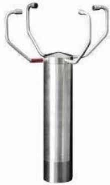
Gambar 10. Bentuk sensor angin dengan tipe ultrasonic anemometer
