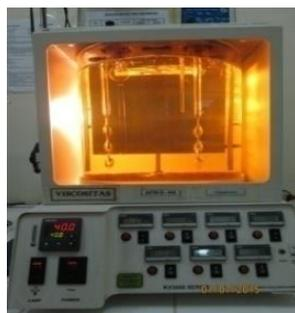
Gambar 1. Viskometer Kapiler dan Penangas
