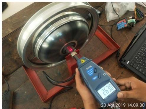
Gambar 21. Proses Mengukur RPM
