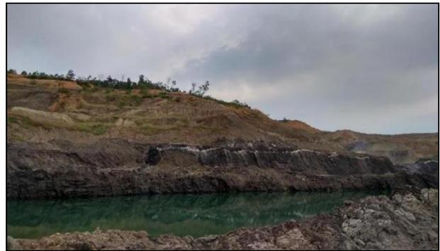
**Gambar 7. Sump pada Toe Lereng Area Highwall Sisi Timur Pit ABC**
