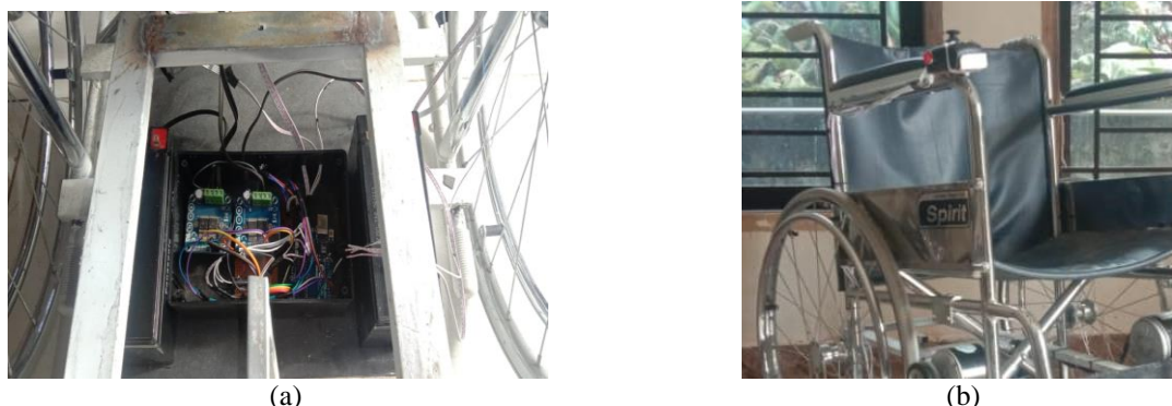
Gambar 5 (a) Posisi motor driver dan arduino, (b) Posisi joystick (lingkaran merah)
